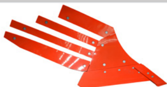
MP4C - Versoir claire voie, cylindrique, pour les sols argileux et enfouissement d'engrais vert. (Profondeur de travail 25-40 cm).
