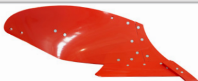
MP4WN - Versoir plein, semi-hélicoïdal, pour les sols lourds / humides. (Profondeur de travail 20-30 cm).
