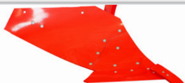
MP6WC - Versoir plein, cylindrique, pour les sols très argileux. (Profondeur de travail 30-45 cm).
