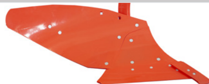
MP4WC - Versoir plein, cylindrique, pour les sols sableux / limoneux. (Profondeur de travail 25-40 cm).
