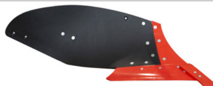
MP4WP - Versoir plein, semi-hélicoïdal, pour sols très collants. (Profondeur de travail 20-30 cm).
