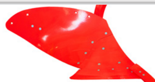
MP6WS - Versoir plein, semi-hélicoïdal, pour les sols très argileux. (Profondeur de travail 30-45 cm).
