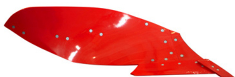
MP4WD - Versoir plein, semi-hélicoïdal, pour sols lourds / humides pour tracteurs à roues larges ( \leq 800\text{mm} ). (Profondeur de travail 15-30 cm).
