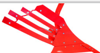
MP6C - Versoir claire voie, cylindrique, pour les sols très argileux. (Profondeur de travail 30-45 cm).
